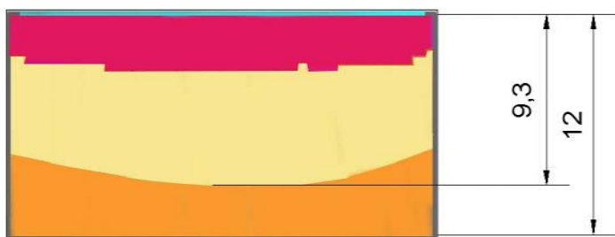
Figura 31: Imagem resumo com a distância da profundidade do alcance a luz natural (área Daylit (níveis 300 a 3000lux) até a fachada.
