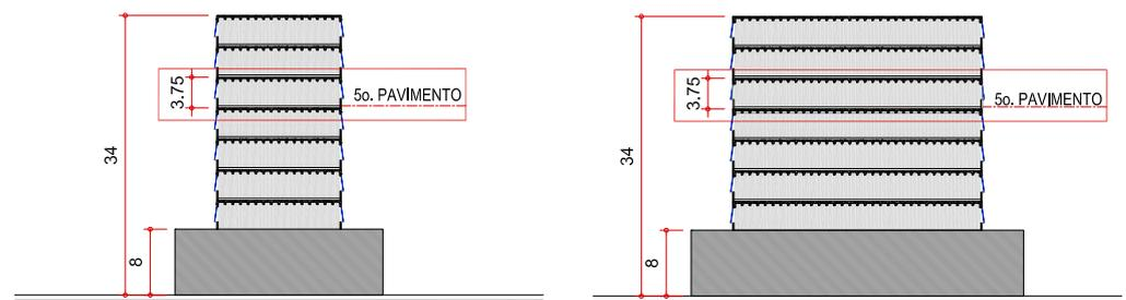
Figura 154. Seção dos modelos de edifícios, retangular e quadrado, respectivamente, com destaque para o escritório de análise: quinto pavimento tipo
