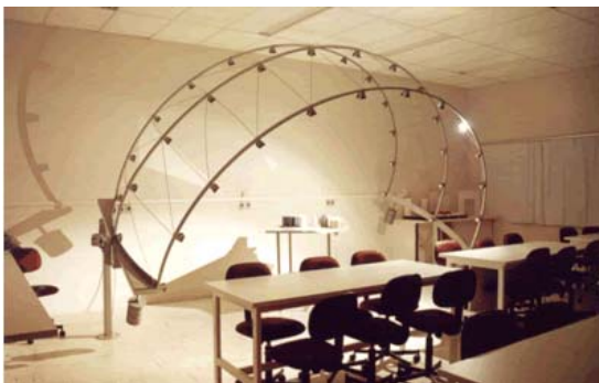
Figura 47 - Helioscópio do curso de Arquitetura e Urbanismo da Universidade de tuiuti no Paraná Fonte: Yamamoto;Krüger e Dumke (2003)
