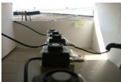
Figura 91 - Modelo 1. Penetração solar - 22 de junho às 15h
