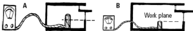
Figura 35 - (A) Colocação imprópria do sensor, pois não coincide com o plano de trabalho
