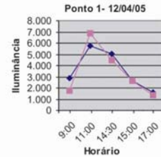
Gráfico 4 - Variação das iluminâncias no ponto 1 do modelo reduzido e do ambiente real (12/04/05)
