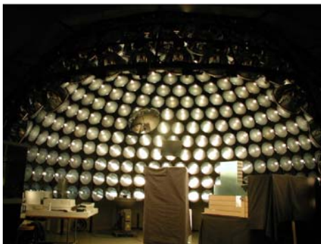
Figura 43 - Simulador de céu com pontos de luz Fonte: www.learn.londonmet.ac.uk
