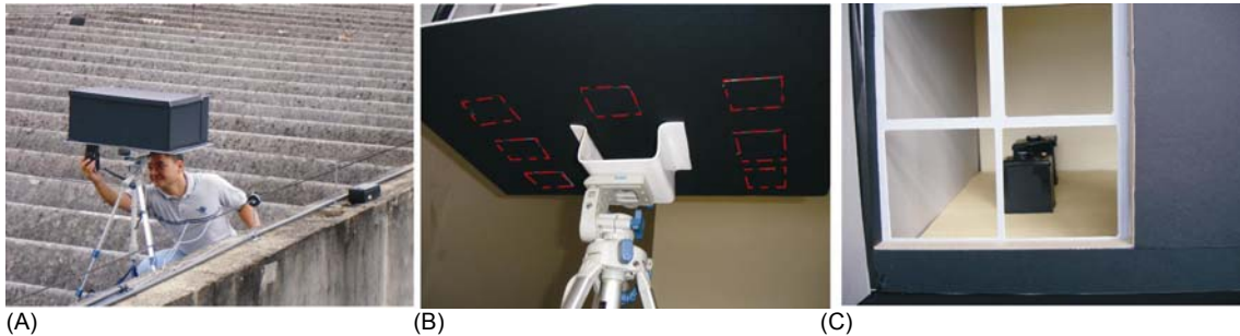
Figura 57 - (A) medição no modelo, (B) Aberturas inferiores para inserção do sensor, (C) Sensor no interior do modelo Fonte: Autora da pesquisa.
